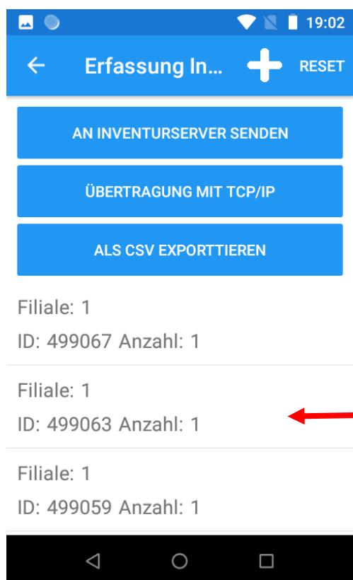
In diesem Bildschirm können Sie die erfassten Datensätze ansehen (Scrollfunktion) und bearbeiten (wischen Sie den gewünschten Datensatz nach links) und die verschiedenen Übertragungsvorgänge der Daten auswählen. Mit der Funktion „An Inventurserver senden“ werden die Daten an den lokalen Arbeitsplatzserver übertragen. Alternativ können die Daten auch mit CSV-Export an den LS-INFOMAN übergeben werden.
