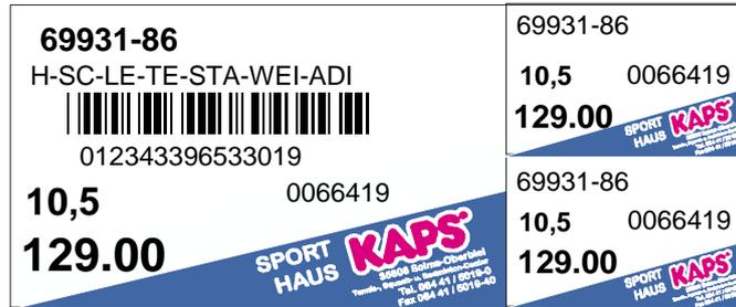
DIN A4 Etikett für Laserdrucker, pro Blatt 2 Etiketten nebeneinander, 9 Etiketten untereinander, Schuh-Etikett, dreiteilig mit Abschnitt für Karton und zwei Abschnitten für Schuhe, Größe 106 x 30 mm, Kartonteil 53 x 30 mm, Schuhteile 26,5 x 30 mm
